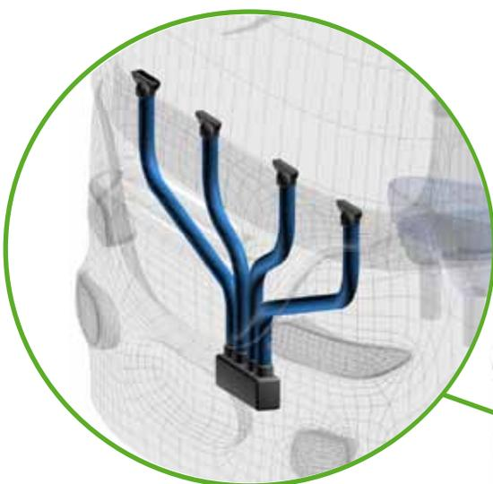
Detalle de configuración del sistema desempañador en el vehículo
